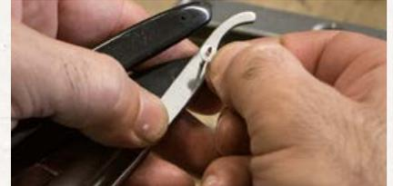
Anschließend werden die Klingen von Hand mit Neusilberieten, Unterlegscheiben, Distanzstück und Schalen vernietet. Hierbei erfordern die Naturmaterialien Holz und Horn Fingerspitzengefühl, da diese bei zu viel Druck reißen können.
